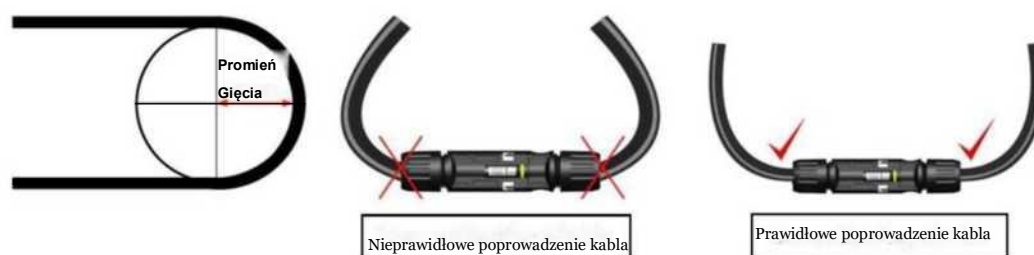
Rysunek 4: Prawidłowe prowadzenie i minimalny promień gięcia kabli.
